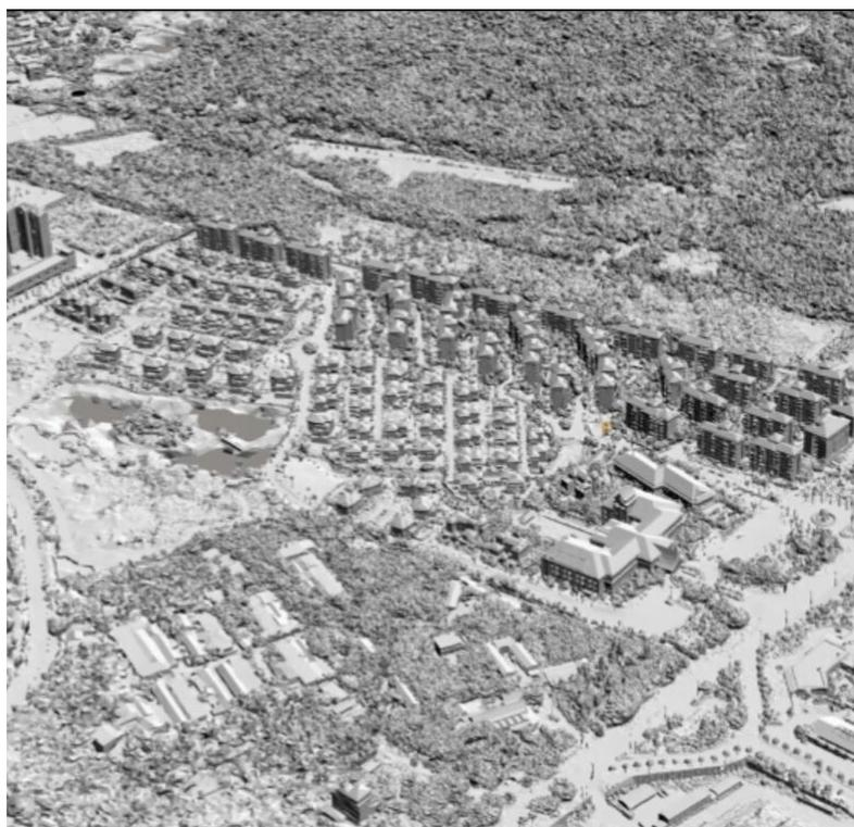
中画幅倾斜相机系统生成的真彩色三维模型
