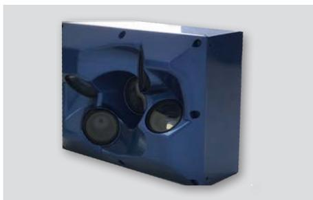
自主研发设计的五镜头倾斜摄影相机。该相机由5个索尼的A7R2全画幅相机改装而成，单机像素是4240万，总像素达到了2亿，单个像元大小是4.5微米，总机的重量控制在了3kg。这款相机采用了集中供电的方式，可使用APP来调节参数。
